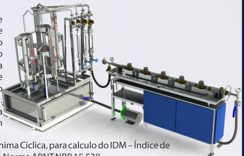
Vazão Máxima Contínua e Vazão Mínima Cíclica, para cálculo do IDM – Índice de Desempenho Metrológico segundo Norma ABNT NBR 15.538.
